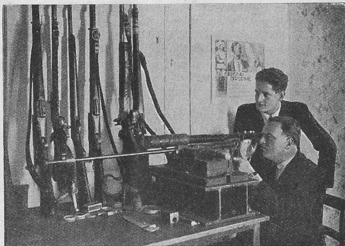
Eigene moderne Versuchsschießanlage zur Prüfung der Kleinkaliberläufe auf 50 m und der Matchapparate für Zimmerschießen auf 15 m, direkt bei der Werkstätte in Kriens. Das Bild zeigt die beiden Verfasser an der neuen Schießmaschine, die absolut einwandfreie Schußbilder liefert. Mit dem Fernrohr werden die Einschläge beobachtet. Alle Schützenkameraden und Interessenten sind höflich eingeladen, die Anlage ganz unverbindlich zu besichtigen. Wir würden uns über jeden Besuch auf richtig freuen.
